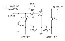
IC= -20IB1=20IB2= -750mA
