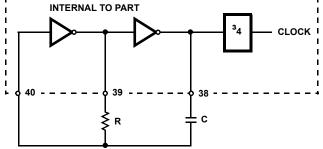
FIGURE 7B. RC OSCILLATOR FIGURE 7. CLOCK CIRCUITS
