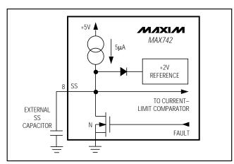
Figure 4. Soft-Start Equivalent Circuit
