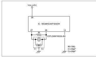
Fig. 6-8 Application to MC68HC05P18ADW (MOTOROLA)
