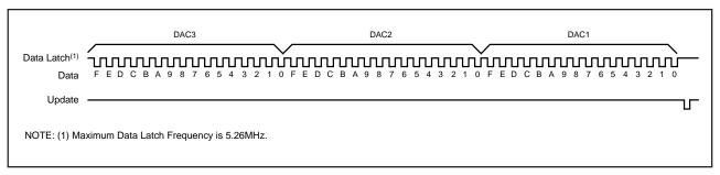
FIGURE 9b. Timing Diagram For Figure 9a.
