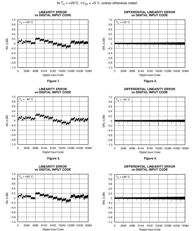
TYPICAL CHARACTERISTICS: V<sub>DD</sub> = +5 V
