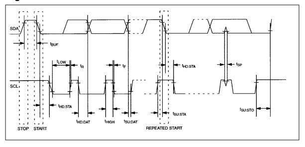
Figure 4. 2-WIRE SERIAL COMMUNICATION WITH DS1085
