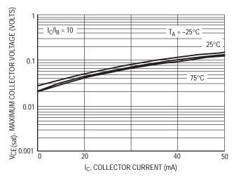
Figure 3.  $V_{\text{CE(sat)}}$  versus  $I_{\text{C}}$
