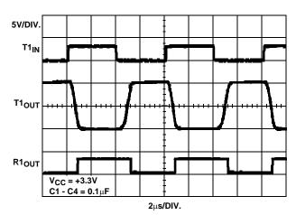
FIGURE 8. LOOPBACK TEST AT 250Kbps
