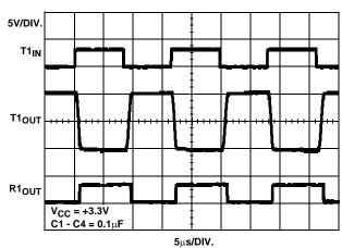
FIGURE 7. LOOPBACK TEST AT 120Kbps
