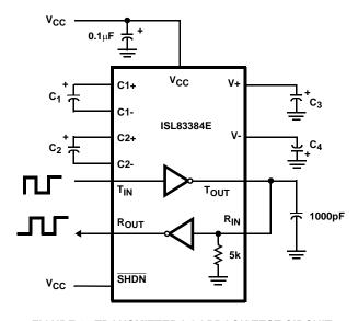
FIGURE 6. TRANSMITTER LOOPBACK TEST CIRCUIT
