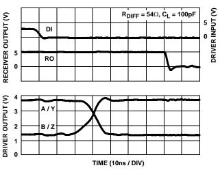
FIGURE 17. DRIVER AND RECEIVER WAVEFORMS, HIGH TO LOW (ISL8485E)
