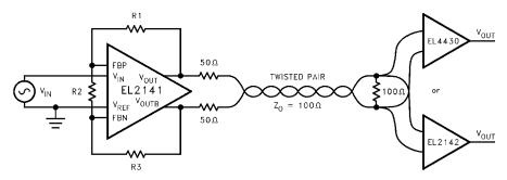
FIGURE 7. TYPICAL TWISTED PAIR APPLICATION
