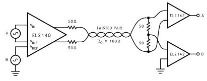
FIGURE 9. DUAL SIGNAL TRANSMISSION CIRCUIT
