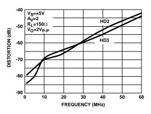
FIGURE 13. DISTORTION vs FREQUENCY
