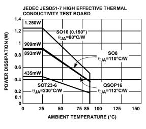
FIGURE 20. PACKAGE POWER DISSIPATION vs AMBIENT TEMPERATURE
