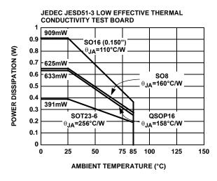
FIGURE 19. PACKAGE POWER DISSIPATION vs AMBIENT TEMPERATURE
