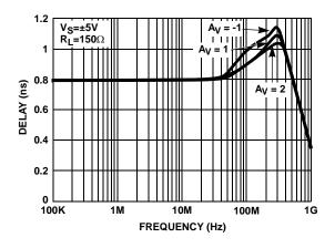
FIGURE 6. GROUP DELAY vs FREQUENCY
