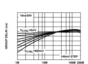
FIGURE 9. GROUP DELAY AS THE FUNCTION OF THE FREQUENCY REPONSE CONTROL VOLTAGE (VCTRL)
