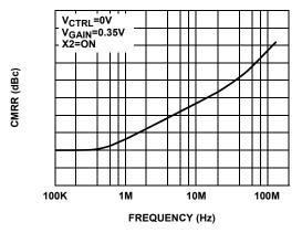
FIGURE 4. COMMON MODE REJECTION
