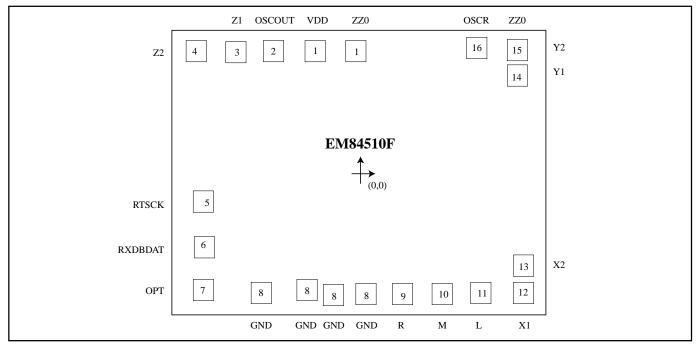
Chip Size : 1780 µm x 1430 µm (EL5750)
