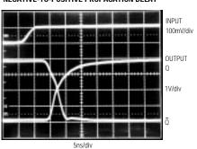
MAX912/MAX913 RESPONSE TO 50MHz (±10mV<sub>P-P</sub>) SINE WAVE
