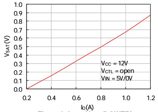
Figure 6. I<sub>O</sub> vs V<sub>SAT</sub>(LOWER)
