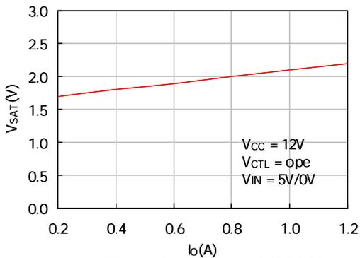
Figure 5. I<sub>O</sub> vs V<sub>SAT</sub>(UPPER)
