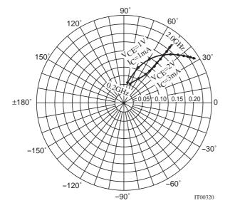
f=200MHz to 2000MHz(200MHz Step) S21e
