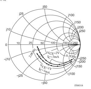
$f{=}200MHz$  to  $2000MHz(200MHz\ Step)$  S12e
