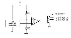
FIGURE 18. SIMPLIFIED UNDERVOLTAGE LOCKOUT
