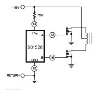
FIGURE 23. PUSH-PULL CONFIGURATION
