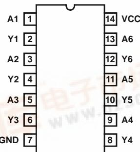
14 LEAD CERAMIC METAL SEAL FLATPACK PACKAGE (FLATPACK)
