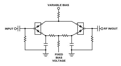
Figure 26. Four Diode  $\pi$  Attenuator.
