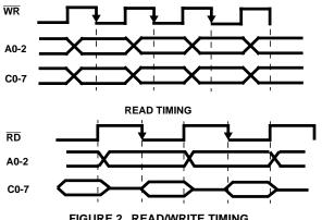
**FIGURE 2. READ/WRITE TIMING**
