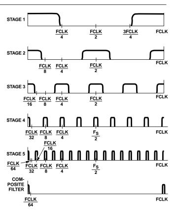
FIGURE 10B. SPECTRAL COMPOSITION OF FIVE CASCADED HALFBANDS
