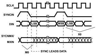
FIGURE 9. DATA/MIX FACTOR SYNCHRONIZATION WEAVER MODULATOR MIX FACTORS
