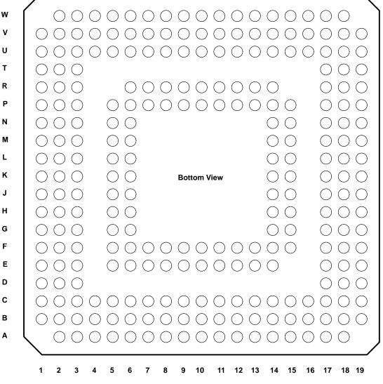
Figure 2–1. PCI4520 GHK Terminal Diagram
