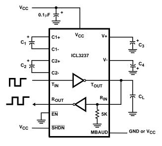
FIGURE 5. TRANSMITTER LOOPBACK TEST CIRCUIT
