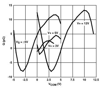
FIGURE 12. CHARGE INJECTION vs SWITCH VOLTAGE
