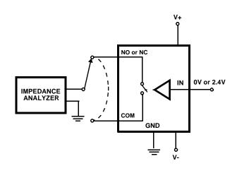
FIGURE 7. CAPACITANCE TEST CIRCUIT
