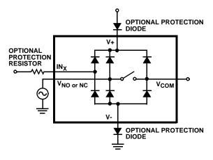
FIGURE 8. OVERVOLTAGE PROTECTION
