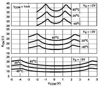
FIGURE 11. ON RESISTANCE vs SWITCH VOLTAGE
