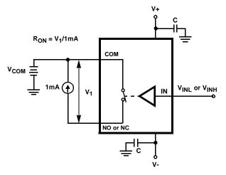
FIGURE 4. RON TEST CIRCUIT
