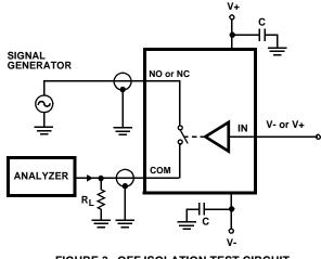
FIGURE 3. OFF ISOLATION TEST CIRCUIT
