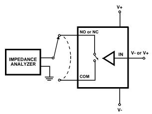
FIGURE 5. CAPACITANCE TEST CIRCUIT
