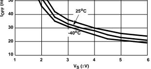
FIGURE 12. TURN - OFF TIME vs SUPPLY VOLTAGE
