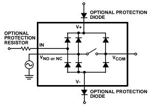
FIGURE 6. OVERVOLTAGE PROTECTION
