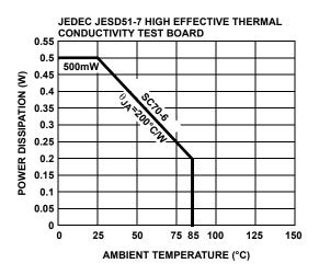
FIGURE 23. PACKAGE POWER DISSIPATION VS AMBIENT TEMPERATURE
