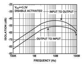
FIGURE 10. ISOLATION vs FREQUENCY
