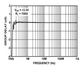
FIGURE 19. GROUP DELAY VERSUS FREQUENCY
