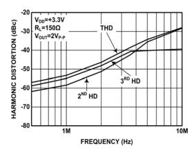
FIGURE 17. HARMONIC DISTORTION vs FREQUENCY
