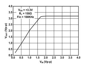
FIGURE 6. MAXIMUM OUTPUT MAGNITUDE vs INPUT MAGNITUDE
