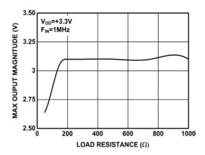
FIGURE 11. MAXIMUM OUTPUT vs LOAD RESISTANCE
