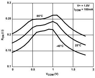
FIGURE 10. ON RESISTANCE vs SWITCH VOLTAGE
