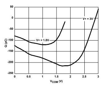
FIGURE 11. CHARGE INJECTION vs SWITCH VOLTAGE
