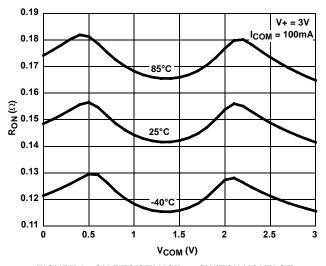
FIGURE 9. ON RESISTANCE vs SWITCH VOLTAGE
