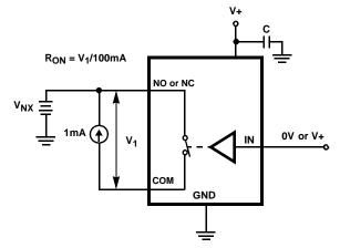
FIGURE 4. RON TEST CIRCUIT
