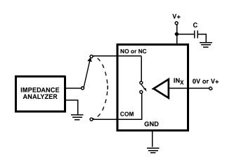
FIGURE 6. CAPACITANCE TEST CIRCUIT
