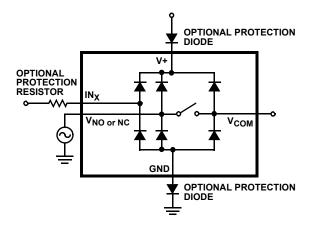
FIGURE 7. OVERVOLTAGE PROTECTION
