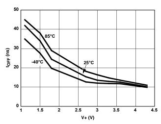
FIGURE 13. TURN - OFF TIME vs SUPPLY VOLTAGE
