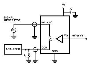
FIGURE 3. OFF ISOLATION TEST CIRCUIT
