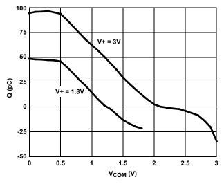
FIGURE 12. CHARGE INJECTION vs SWITCH VOLTAGE
