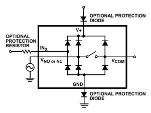
FIGURE 8. OVERVOLTAGE PROTECTION
