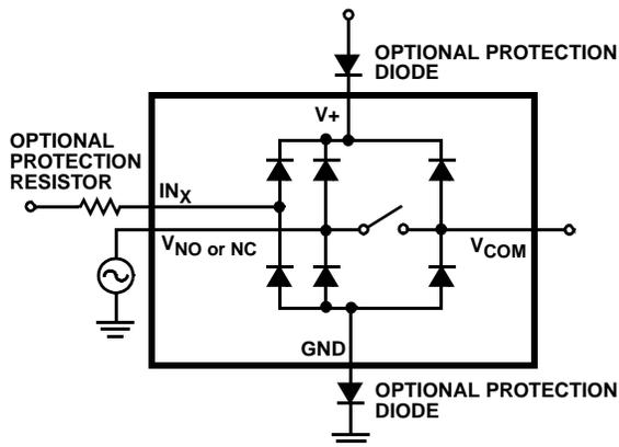
FIGURE 8. OVERVOLTAGE PROTECTION
