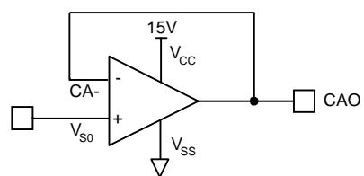
Measure  $V_{CAO1}$  at  $V_{SO} = 0.1V$
