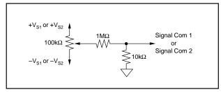
FIGURE 5. V<sub>os</sub> Adjust.
