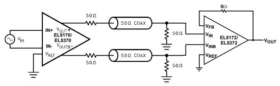
FIGURE 21. DUAL COAXIAL CABLE DRIVER
