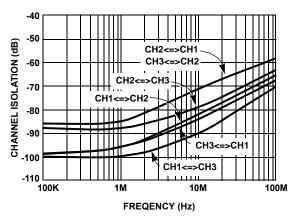
FIGURE 9. CHANNEL ISOLATION vs FREQUENCY
