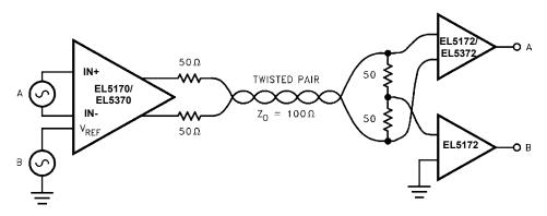
FIGURE 23. DUAL SIGNAL TRANSMISSION CIRCUIT
