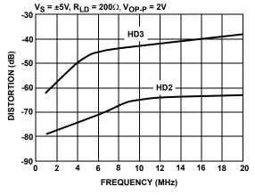
FIGURE 12. HARMONIC DISTORTION vs FREQUENCY
