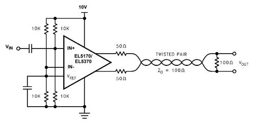
FIGURE 22. SINGLE SUPPLY TWISTED PAIR DRIVER
