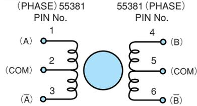
下記励磁シーケンスにて、出力軸側より見て時計方向回転
