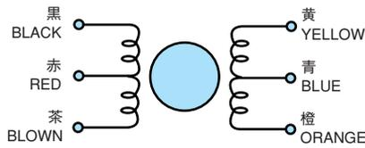
下記励磁シーケンスにて、出力軸側より見て時計方向回転
