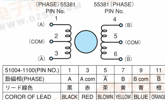
下記励磁シーケンスにて、出力軸側より見て時計方向回転
