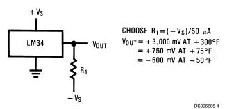
FIGURE 2. Full-Range Fahrenheit Temperature Sensor
