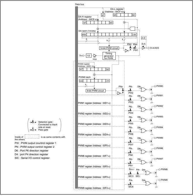
Fig. 35. PWM Block Diagram
