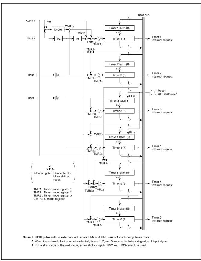
Fig. 17. Timer Block Diagram
