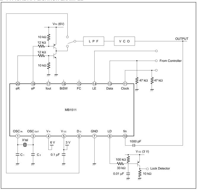
$V_{\text{PX}},\,V_{\text{P}}$  : 8V max.
