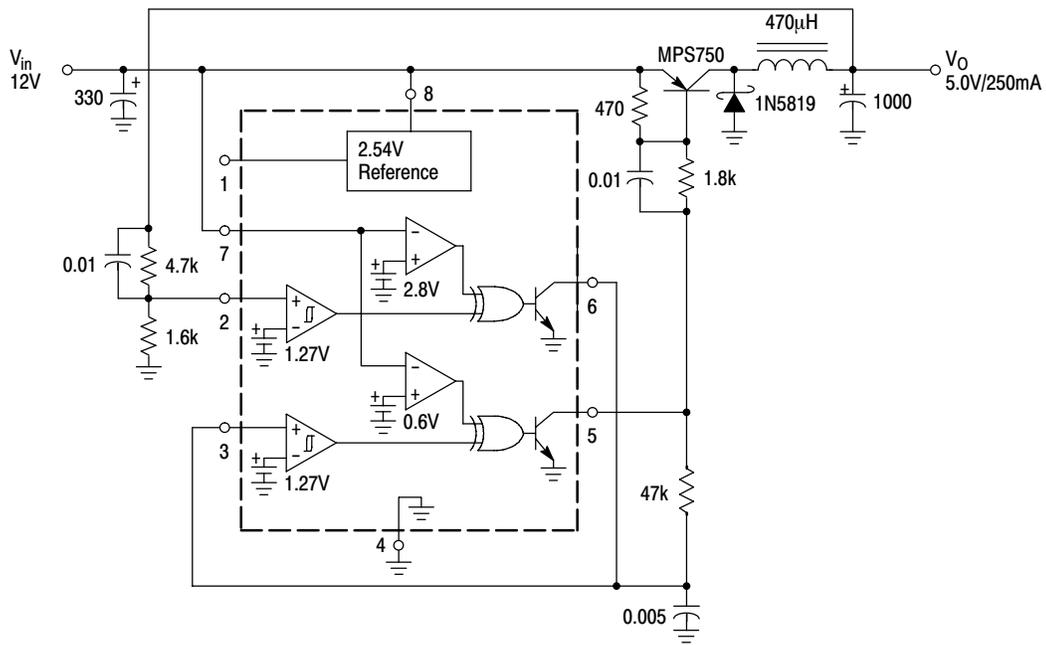
**Figure 27. Step-Down Converter**
