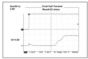
**FIGURE 2-25:** Start-up From  $V_{IN}$  ( $V_R = 1.8V$ ).
