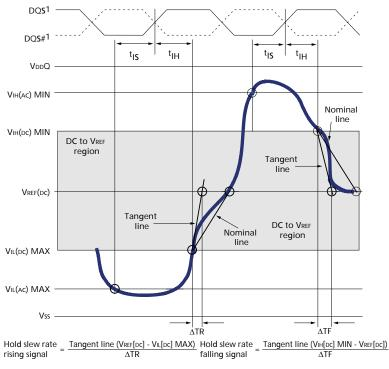
Notes: 1. DQS, DQS# signals must be monotonic between VIL(DC) MAX and VIH(DC) MIN.
