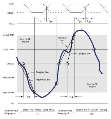
Notes: 1. DQS, DQS# signals must be monotonic between VIL(DC) MAX and VIH(DC) MIN.
