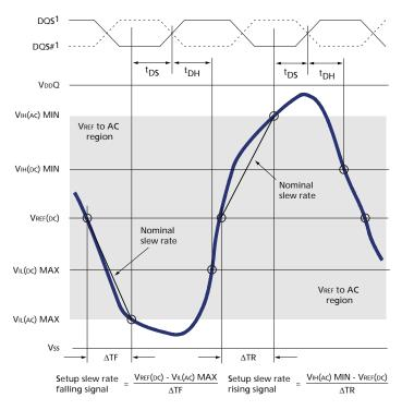
Notes: 1. DQS, DQS# signals must be monotonic between VIL(DC) MAX and VIH(DC) MIN.
