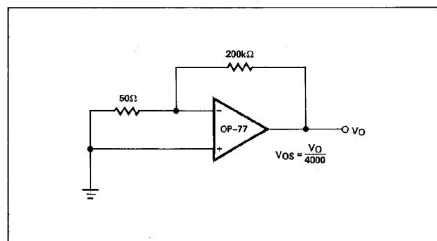
**TYPICAL LOW-FREQUENCY NOISE TEST CIRCUIT**
