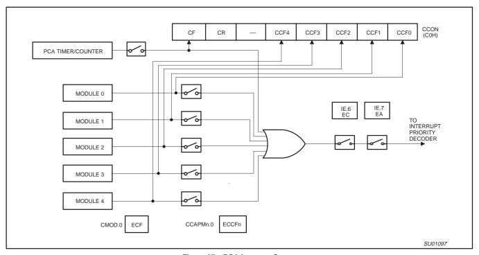
Figure 27. PCA Interrupt System
