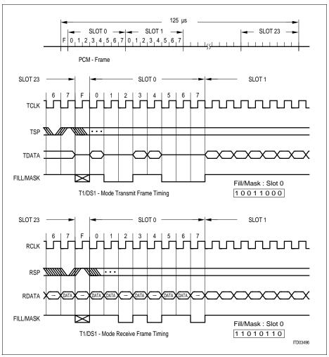
Figure 12 T1/DS1 Mode PCM Frame Timing 1.544 MHz
