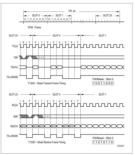
Figure 13 T1/DS1 Mode PCM Frame Timing 1.536 MHz
