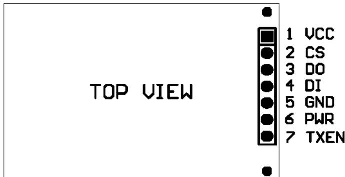
Pin1: VCC, 正电源, 接 2.7~5.25V
