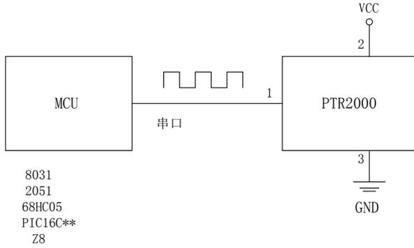
应用之二：可完成点对点传输的数据采集，用于工业控制，数据采集，无线键盘，身份识别、无线标签等。
