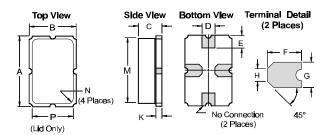
Millimeters Inches Dimensions Min Max Min Max 5.97 0.235 Α 0.155 В 3.94 С 2.16 0.085 D 0.94 1.10 0.037 0.043 Е 0.83 0.033 0.047 1.20 0.046 0.060 F 1 16 1 53 G 0.94 0.037 0.043 1 10 0.017 Н 0.023 0.43 0.59 Κ 0.43 0.59 0.017 0.023 Μ 5.31 0.209 Ν 0.64 0.025 0.38 0.015 Ρ 3 28 0.129
