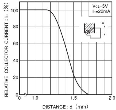
Fig.6 Relative output vs. distance (d)
