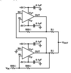
FIGURE 21. INVERTING 200mA OUTPUT CURRENT **DISTRIBUTION AMPLIFIER**
