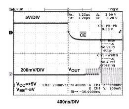
FIGURE 10. ENABLE DELAY TIME
