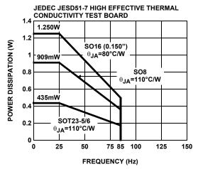
FIGURE 17. PACKAGE POWER DISSIPATION vs AMBIENT TEMPERATURE
