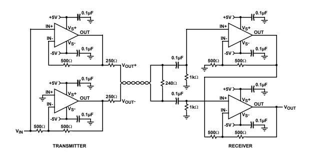
FIGURE 23. DIFFERENTIAL LINE DRIVER/RECEIVER
