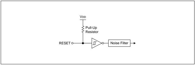
Figure 1-4. Pin Circuit Type B
