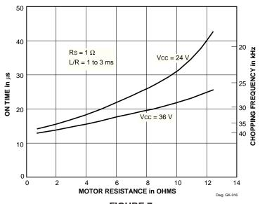
FIGURE 7. PWM FREQUENCY vs MOTOR RESISTANCE
