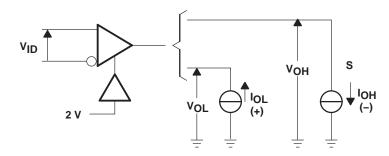
Figure 1. V<sub>OH</sub>, V<sub>OL</sub>
