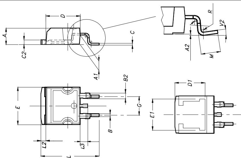
**STP22NM50 / STP22NM50FP / STB22NM50 / STB22NM50-1**
